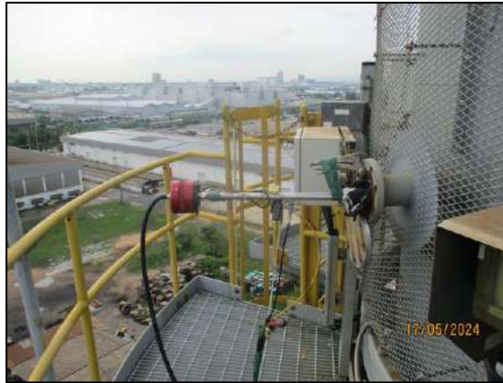
รูปที่ 3.1 การเก็บตัวอย่างคุณภาพอากาศในปล่องระบาย บริเวณ ปล่อง HRSG#3
