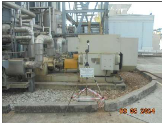
รูปที่ 3.13 การตรวจวัดระดับเสียงในพื้นที่ทำงาน บริเวณ Boiler Feed Pump
