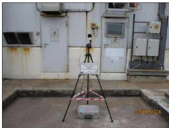
รูปที่ 3.11 การตรวจวัดระดับเสียงในพื้นที่ทำงาน บริเวณ Gas Turbine 3 – North
