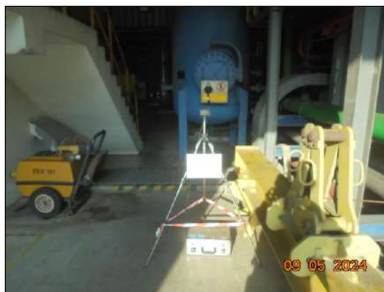
รูปที่ 3.1 การตรวจวัดระดับเสียงในพื้นที่ทำงาน บริเวณ Steam Turbine
